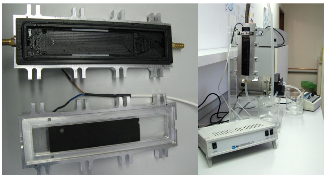
Slika 2: Levo: notranjost modelne laboratorijske elektrolitske celice z elementi za doseganje laminarnega pretoka s preprečevanjem preferenčnih tokov. Desno: tokovni generator, povezan z modelno laboratorijsko elektrolitsko celico in črpalko.
