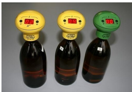
Slika 1: Analiza biološke potrebe po kisiku v 5 dneh
