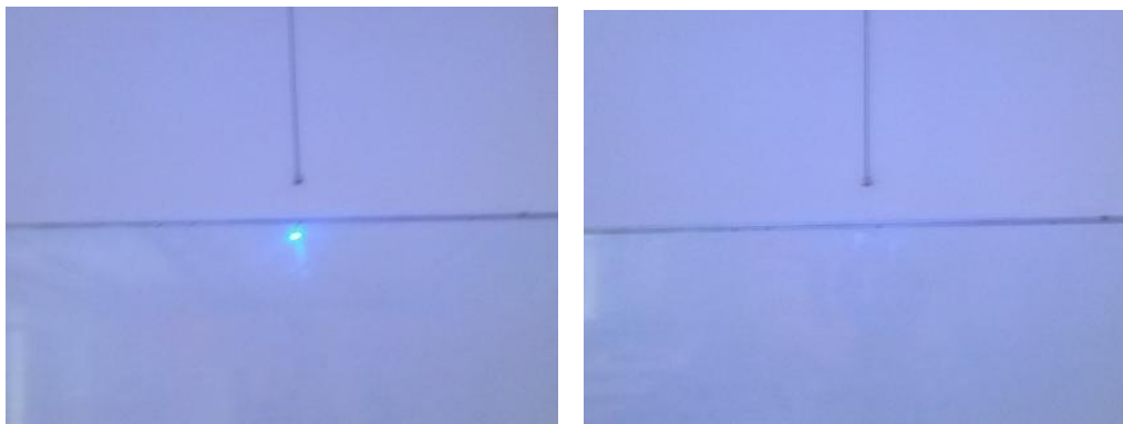
(a) (b) Slika 4: Fotografija usmerjenega odboja od projektorja (a) in bolj razpršena svetloba od odboja na steni (b).
