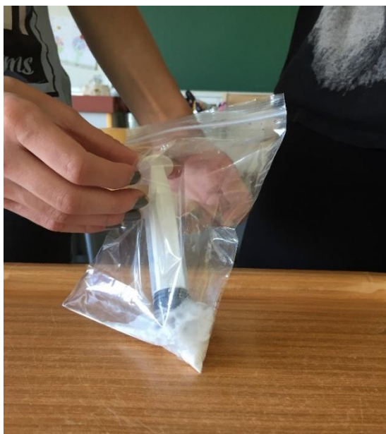
Slika 6: Reakcija med sodo bikarbono in vodno raztopino vodikovega klorida (Vir: lasten).
